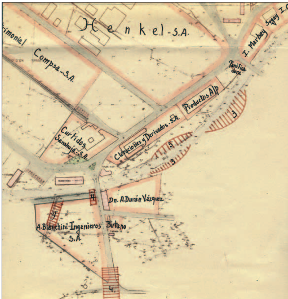
FRAGMENT DEL PLÀNOL DEL POLÍGON RIERA MARSÀ ON ES MARQUEN AMB TRAMAT VERMELL LES ZONES ON CONSTRUIR MURS DE CONTENCIÓ (NÚM. 3) I CANALITZACIONS (NÚM. 4). AMMV. S.138. GESTIÓ 1963.01.
